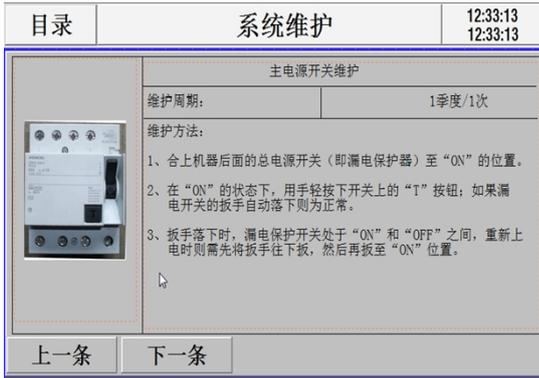
图 1-6-2-1(主电源开关维护)
