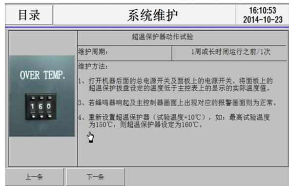
图 1-6-2-4(超温保护器动作试验)
