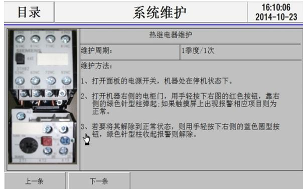
图 1-6-2-2(热继电器维护)
