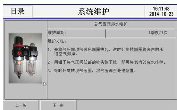
图 1-6-2-6(总气压阀排水维护)
