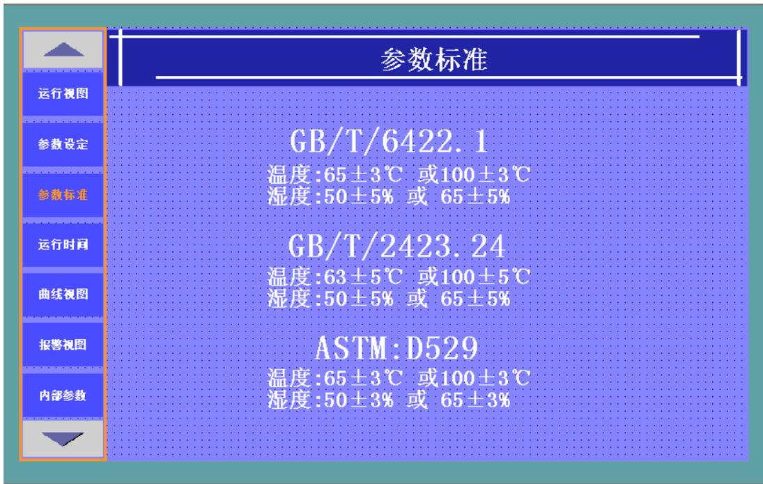
8/进入运行介面，在运行介面可监控机器的所有运行，按启动按键，机器开始运行。可以在运行画面，监控到机器运行的温度、湿度、辐照度，循环到第几次，运行了多少小时多少分钟。灯管的光源寿命使用了多少小时。光源灯灯亮报警，说光源寿命已到。缺水报警：请检查水源。机器运行到那阶段，那个阶段的灯就会亮。
